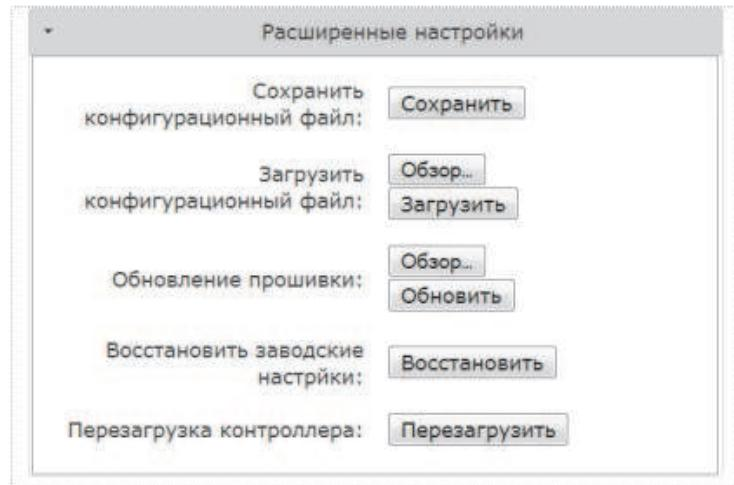
**Сохранить конфигурационный файл:** Сохраняет выполненные настройки контроллера в файл на устройстве, с которого производится настройка.
