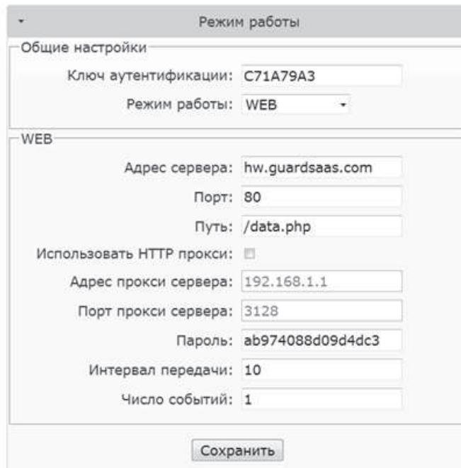
**Адрес сервера:** Имя или IP-адрес Web-сервера «облачного» сервиса, к которому должен будет подключаться контроллер.
