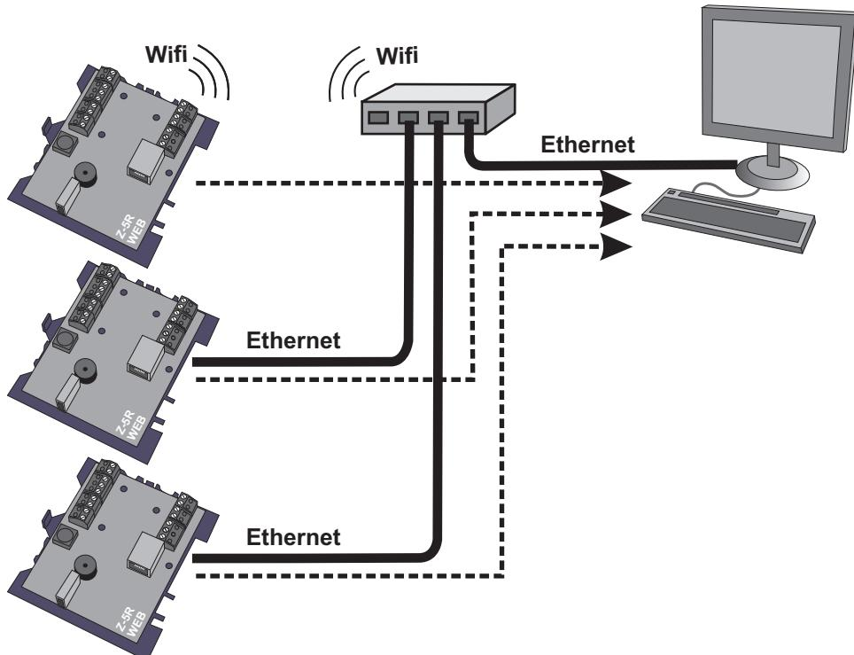
Сервер ZProxy ([zproxy.con.ru](http://zproxy.con.ru)) обеспечивает связь программного обеспечения с контроллером в случае невозможности настроить прямое соединение TCP, например, при работе в разных локальных сетях. В этом случае, при наличии возможности выхода в интернет, контроллер соединяется с сервером ZProxy, программное обеспечение так же соединяется с сервером и по паролю запрашивает соединение с нужным контроллером.
