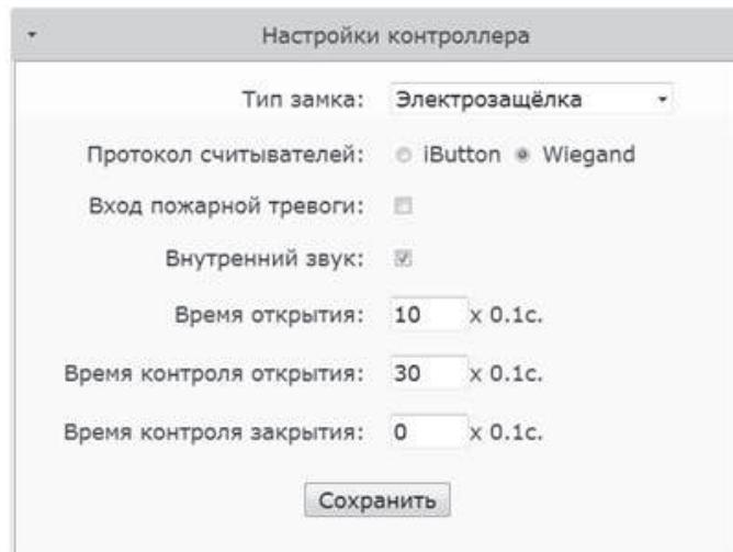
**Тип замка:** Выбор типа замка **Электрозашёлка**, **Электромагнитный**, **Электромеханический**.
